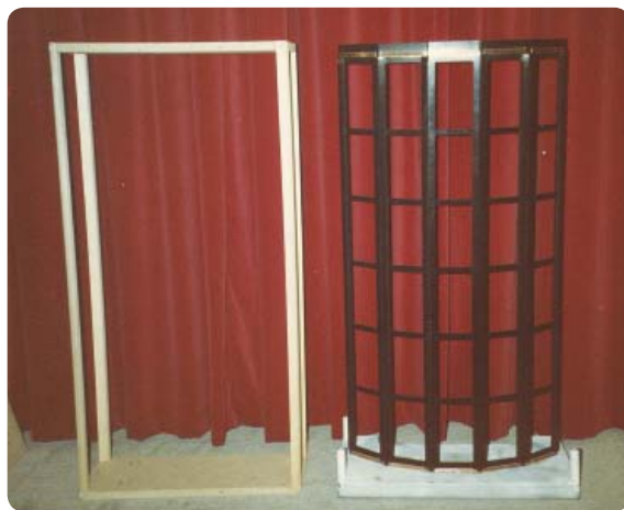
LINKS HERMAN'S EERSTE ZELFGEBOUWDE ELEKTROSTATISCHE ELEMENT. GEMAAKT VAN O.A. EEN BROODZAKJE, BEKRAST MET POTLOOD OM EEN GELEIDENDE KOOLLAAG AAN TE BRENGEN MIDDEN KASTEN VOOR ELEKTROSTATISCH ELEMENT RECHTS NA HARD WERK: EEN VOLWASSEN ELEKTROSTATISCH ELEMENT
