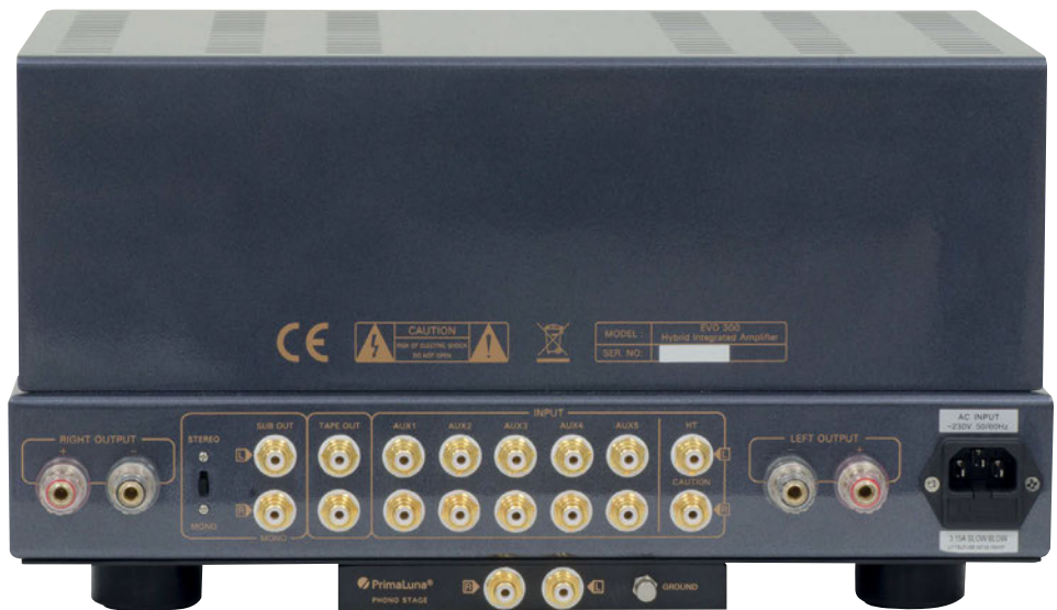
L'EVO 300 Hybrid, come tutti gli altri EVO solo valvolari, è un integrato con soli ingressi linea, uno dei quali può però essere sostituito montando la scheda fono MM opzionale PhonoLogue phono stage, confinata in basso in un piccolo volume proprio alla massima distanza dai possibili generatori di interferenze, e con la massima interposizione di materiale schermante.
