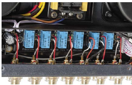
Przełączniki wyboru wejść znajdują się przy tylnej ściance, tuż za gniazdami RCA, stąd sygnały płyną do przedniej ścianki długimi przewodami.
